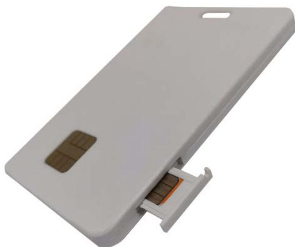
侧面抽屉式nano sim卡托
